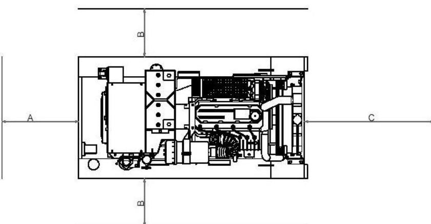
Сторона обслуживания (A): должна быть доступна для обслуживания распределительной коробки.
